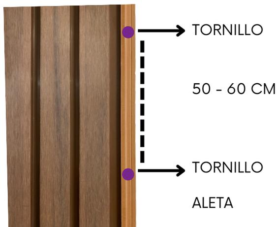
**5** En la ranura correspondiente al sistema click ensamble la siguiente lámina, quedando totalmente ocultos los tornillos y la aleta.
